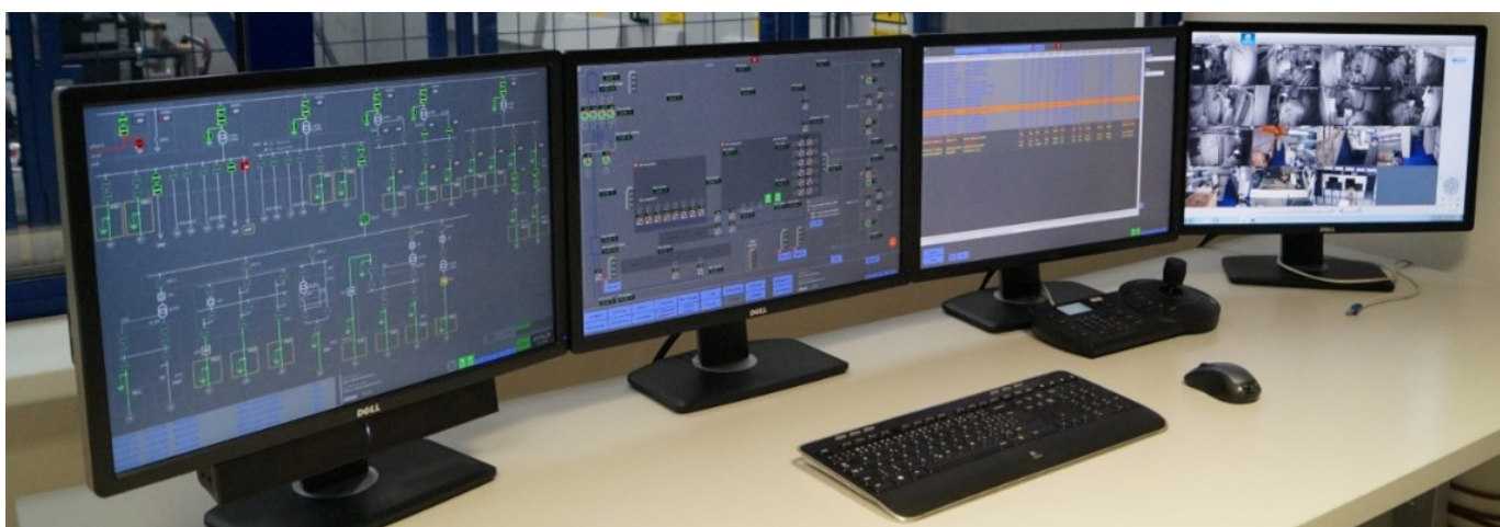
Pracoviště zkušební technika vybavené čtyř monitorovou stanicí a ovládacím rozhraním pro CCTV.
